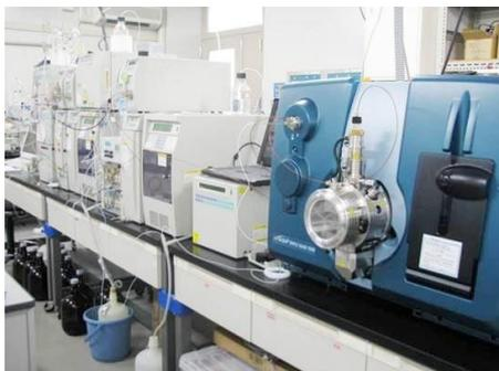
図 2 キラルアミノ酸メタボロミクス分析装置
