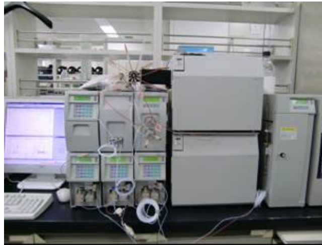
【図1】高感度D,L-アミノ酸同時一斉分析技術(開発した分析法の装置一式と分析例)
