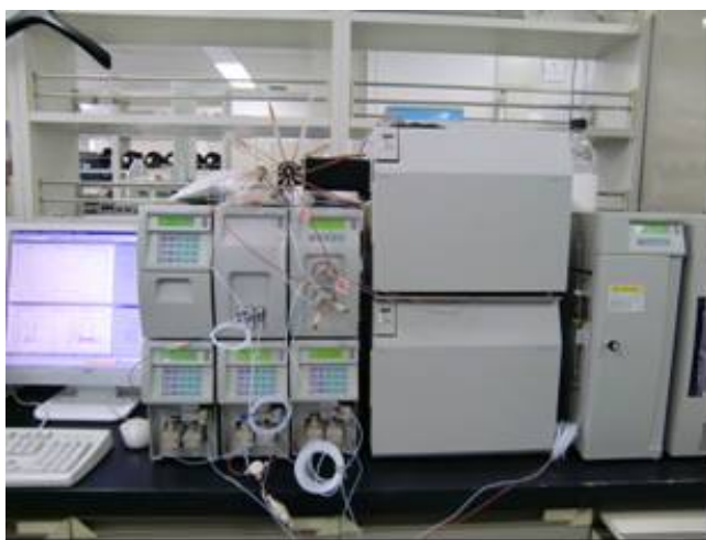
（図2） 高感度D,L-アミノ酸同時一斉分析装置 （資生堂と九州大学が開発した分析装置一式と分析例）
